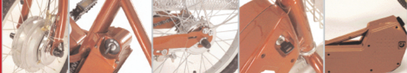
motore brushless chiave accensione freno a tamburo posteriore chiave estrazione batteria batteria estraibile
